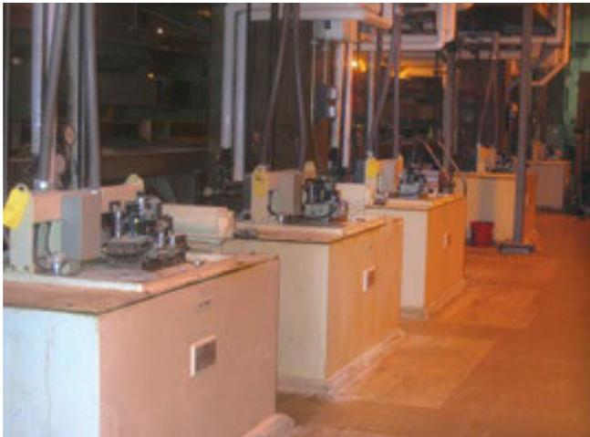
Завод "Hershey" в штате Виргиния обратился к специалистам "Petro-Canada" провести анализ условий производства и помочь в полном переводе оборудования на смазочные материалы PURITY FG. На фотографии изображены гидравлические прессы для арахиса Duvvis – здесь используется масло PURITY FG AW Hydraulic Fluid 68.
