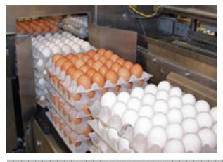
На заводе "Burnbrae Farms" яйца укладывают в пластиковые подложки, которые ставят друг на друга и пропускают через присос для подъёма и укладки яиц.
